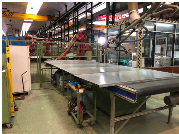
Fig. 23 Posición de espera de las tapas dobladas
