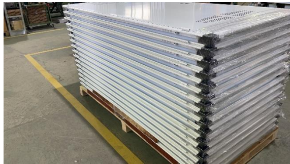
Fig. 16 Apilamiento en horizontal
