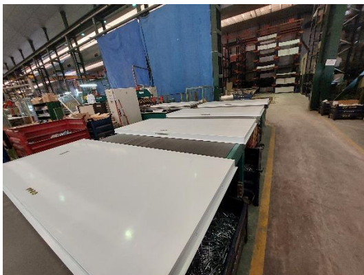
Fig. 28 Cinta de alimentación a puertas de acabado
