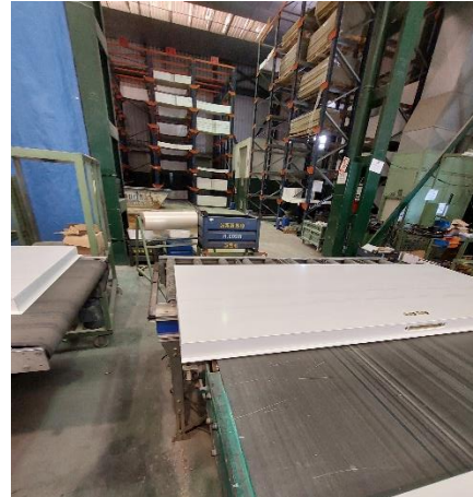
Fig. 27 Posición de extracción/incorporación de puertas pintadas
