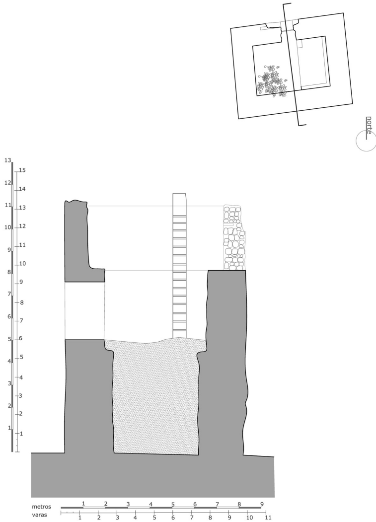
Fig.194. Sección AA', torre de Chumillas (Ruiz Checa)
