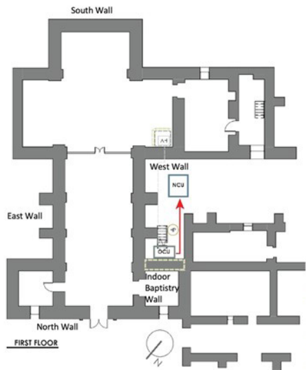
Figura 3.HVAC. Ubicació de les unitats de condensació i la paret exterior de la sala del baptisteri que s'està deteriorant
