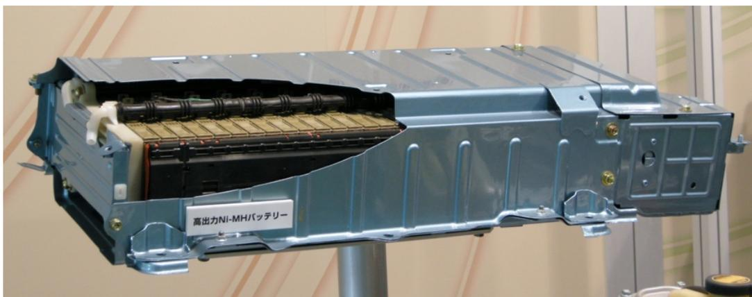
Figura 11 - Batería de coche eléctrico tipo de Níquel-Hidruro metálico.
