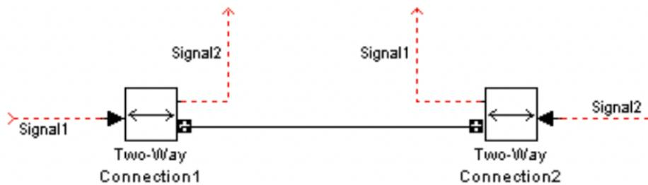
Figura 48 - Funcionamiento del bloque "Two-Way Connection".
