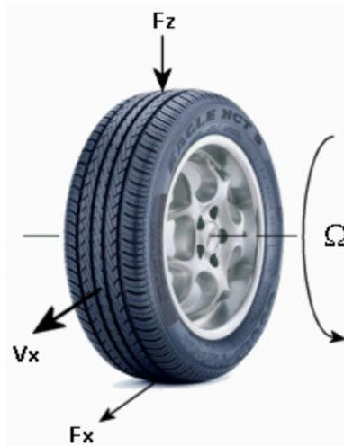
Figura 50 - Parámetros usados por el modelado Magic Formula.
