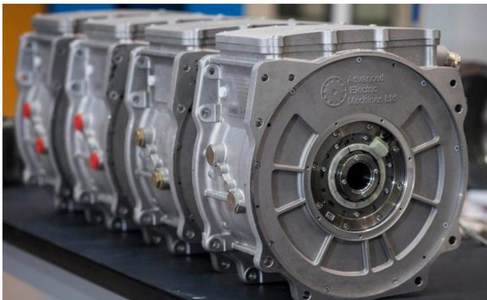
Figura 10 - Motor SRM de tracción.
