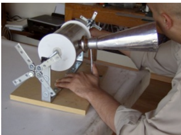
FIG 63- Imagen del momento en que se grabó el segundo rodillo de PVC de 4 ¼” (Foto: Sara Julsrud López)
