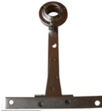
FIG 60- Foto de las bridas unidas a las barras de metal. (Foto: Sara Julsrud López)
