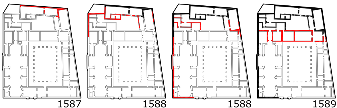
[Fig. IV.30] Hipótesis de la evolución de la construcción de los muros interiores.
