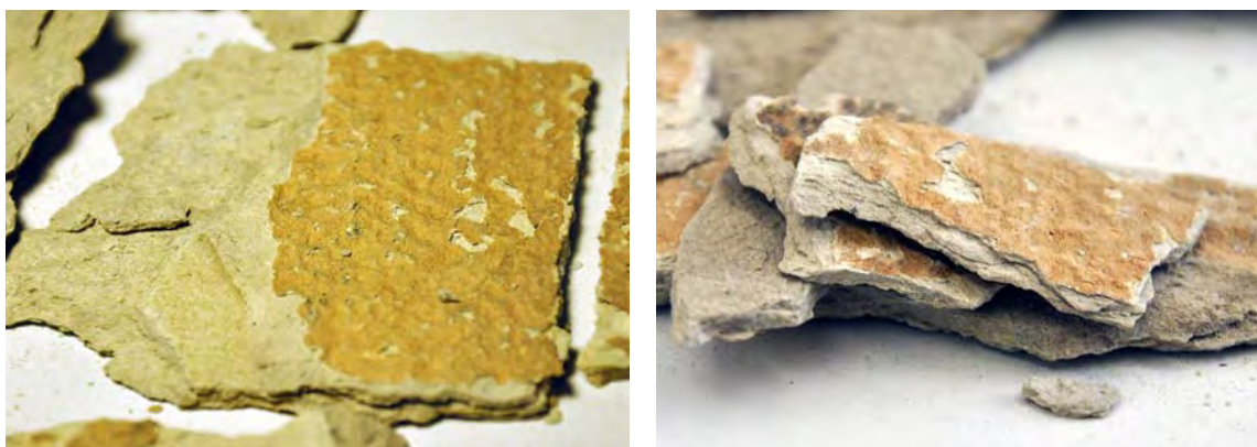
Fig. V.102. Muestras M19 y M11, piedra de Ribarroja, cuya pátina es rojiza.
