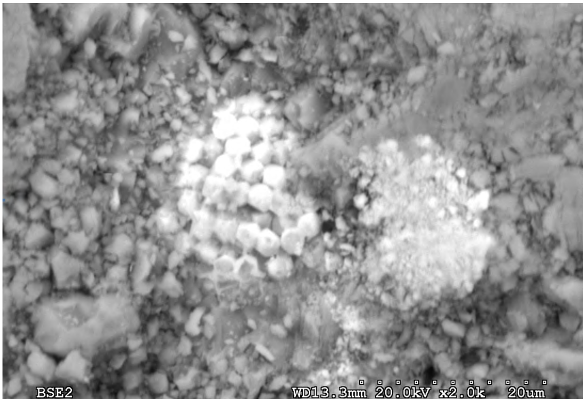
Fig. V.80. Fotomicrografía de Microscopio Electrónico de Barrido (SEM) trabajando a bajo vacío en modo de electrones retrodispersados mostrando oxi-hidróxidos pseudomórficos de pirita framboidal.
