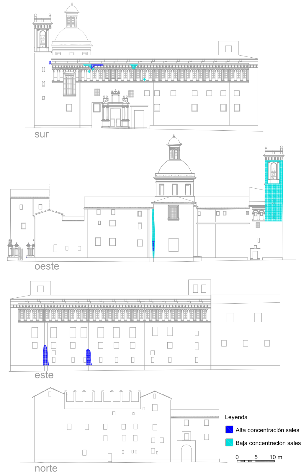
Fig. V.132. Estudio de las eflorescencias salinas.
