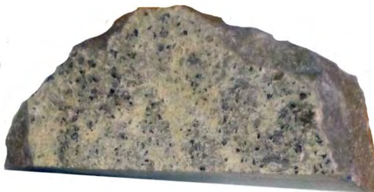
Fig. V.106. Muestra M24, piedra de Ribarroja, cuya pátina contiene yeso.
