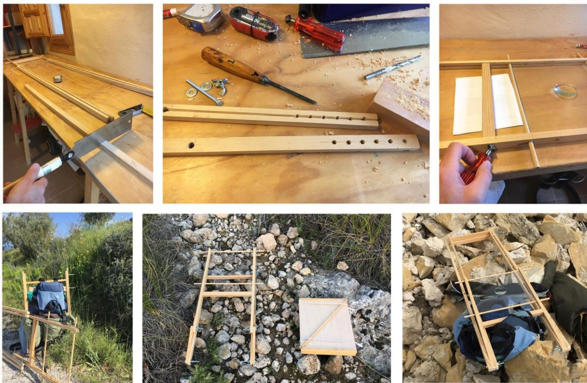
Figura 2. Construcción del artefacto, aspecto plegado del mismo y caja madera para transportar las lentes. 2020. Elaboración propia.
