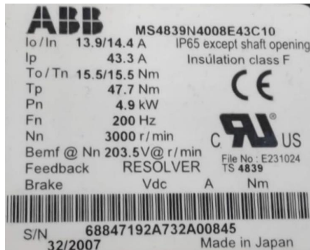
Fig. 12. Placa de características del servomotor.
