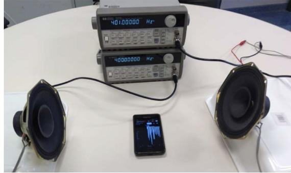
**Fig. 4.** Caracterización del batido acústico mediante el micrófono de un smartphone.
