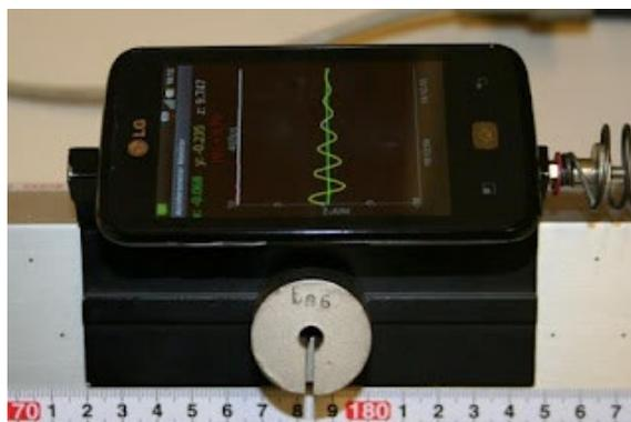
Fig. 2. Caracterización de oscilaciones amortiguadas mediante el acelerómetro de un smartphone.
