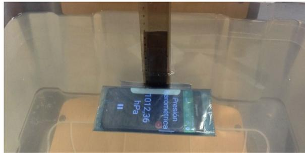
**Fig. 5.** Caracterización de la densidad de un líquido mediante el sensor de presión de un smartphone.
