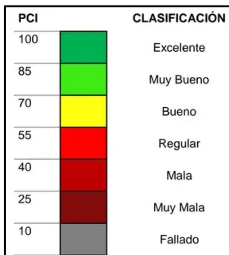
FIGURA 13. CLASIFICACIÓN DEL ESTADO DEL PAVIMENTO SEGÚN EL VALOR DEL PCI (YOUNOS ET AL., 2020).
