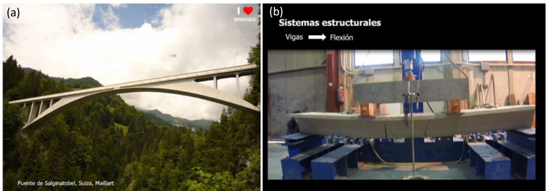
Fig. 1. Transparencias representativas de la presentación inicial: (a) Puente de Salginatobel, ejemplo de estructura económica, eficiente y elegante, (b) ensayo a flexión de un forjado en los laboratorios docentes de la UPV.
