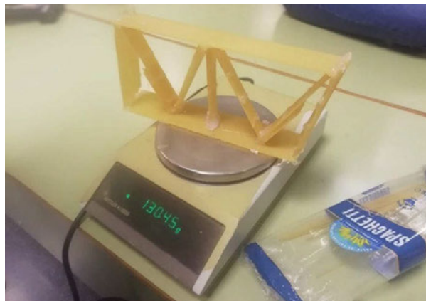
Fig. 3. Obtención del peso propio de un modelo de puente.
