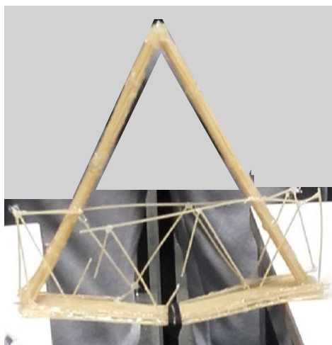
Fig. 7. La rotura de algunos de los elementos del puente (fallos locales) no implica su colapso porque los esfuerzos se redistribuyen.
