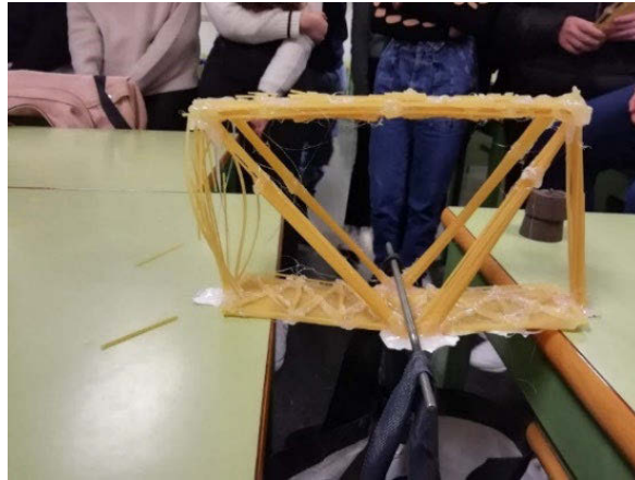
Fig. 5. Pandeo del montante izquierdo del puente debido a los esfuerzos de compresión. El montante derecho tiene un mayor espesor y los espaguetis están mejor solidarizados por lo que el pandeo no se produce.
