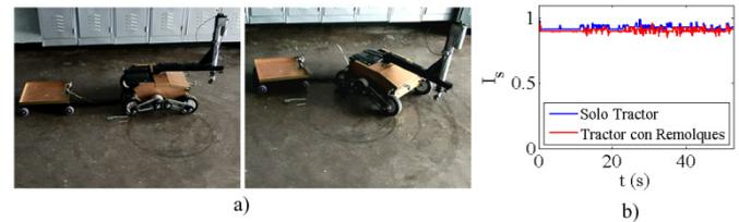
Figura 14: Experimentos con el robot Lázaro para evaluar su índice de direccionamiento
