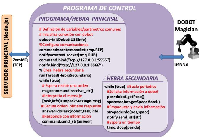
Figura 5: Esquema del software de control
