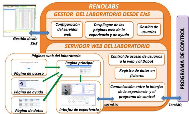
Figura 6: Esquema de la funcionalidad del servidor.
