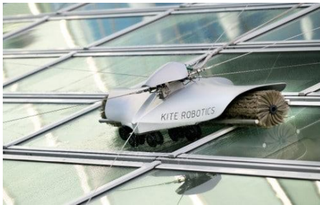
Figura 2: Robot Kite limpiando superficie acristalada vertical
