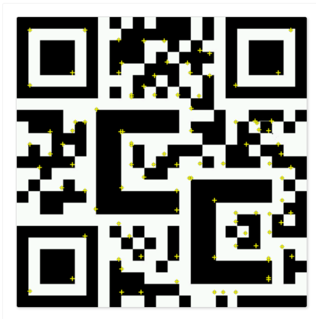
Ilustración 95: Puntos de reconocimiento según Vuforia de la ImagenTarget . Fuente: Elaboración por el autor
