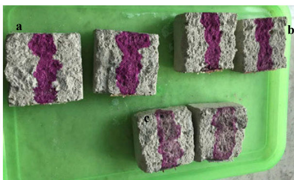
Fig. 7 a) y b) Probetas cúbicas, secciones internas coloreadas en rosa de tono intenso ante la aplicación de fenolftaleína que indica ausencia de carbonatación. c) sección interna de color en rosa de tonalidad más clara que indica carbonatación parcial (60 a 70 %).
