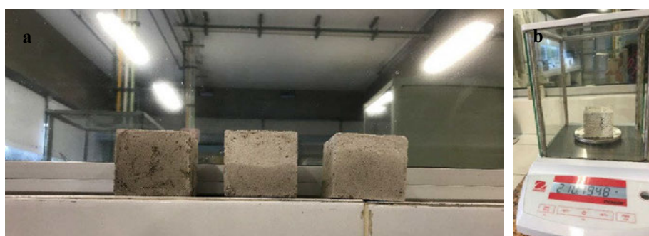
Fig. 8 a) Probetas cúbicas de morteros de cal sometidas a prueba de absorción capilar en donde se distinguen diferentes saturaciones. b) Control de masas en seco y húmedo de las probetas en la misma prueba de absorción capital
