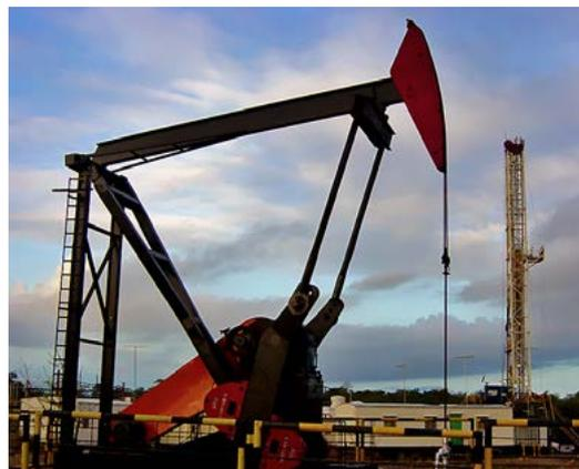
fig. 6. Balancín y taladro de perforación petrolera. HumbRios, 2004
