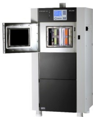
Figura 1.12. Instrumento normalizado para realizar la solidez del color a la luz, Xenotest. (fuente: directindustry)
