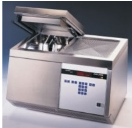
Figura 1.10. Instrumento normalizado para realizar la solidez del color al lavado, Linitest. (fuente James Heal)
