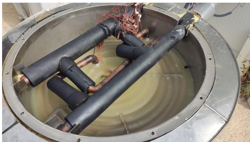
Figura 33. Introducción de la parafina dentro del depósito.
