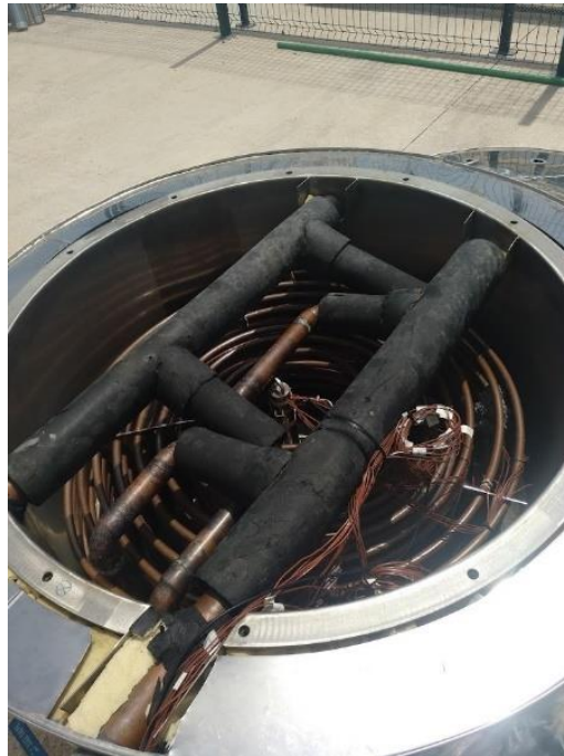
Figura 32. Preparación de los termopares y termorresistencias del depósito.
