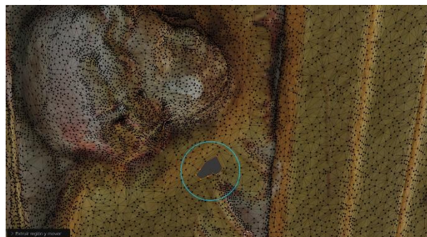
Figura 11: Cerrado de huecos en Blender . Recolocación, extrusión de puntos y posterior remapeado de la zona reconstruida.
