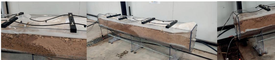
**Figura 5** | Modelo de simulación a escala del sustrato empleado para los ensayos (izquierda). Izquierda y centro, detalle del ensayo de humectación parcial del sustrato de tierra que aloja la fibra óptica. Derecha, ensayo con sustrato saturado y flujo de agua constante.
