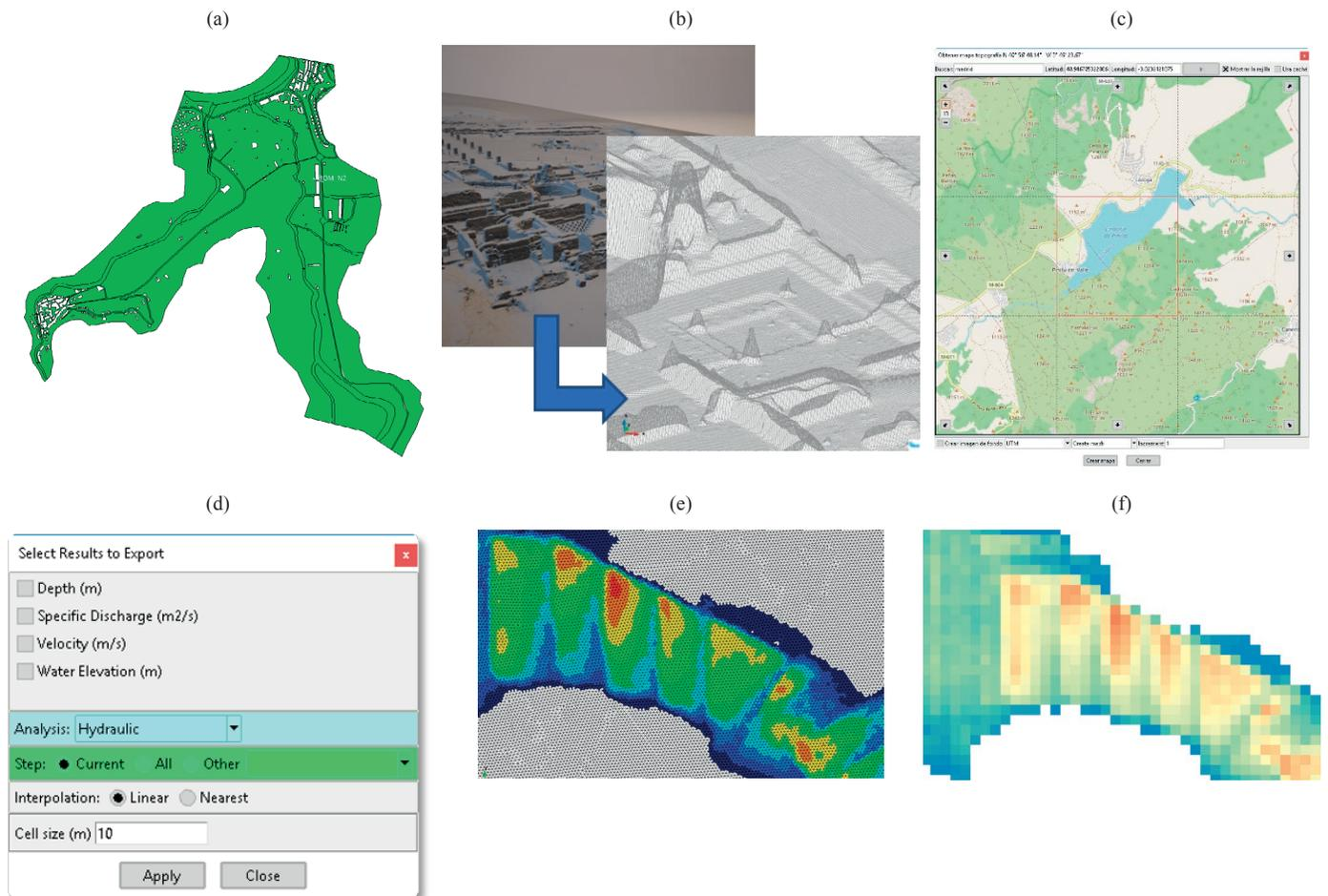
**Figura 3** | (a) Geometría generada en GIS e importada directamente en Iber. (b) Raster tratado con la librería GDAL e importado a Iber directamente como malla de cálculo. (c) Ventana de importación de topografía mundial OpenSource. (d) Nueva ventana para la exportación de cualquier resultado calculado a raster. (e) Resultados en formato Shapefile. (f) Resultados en formato raster.
