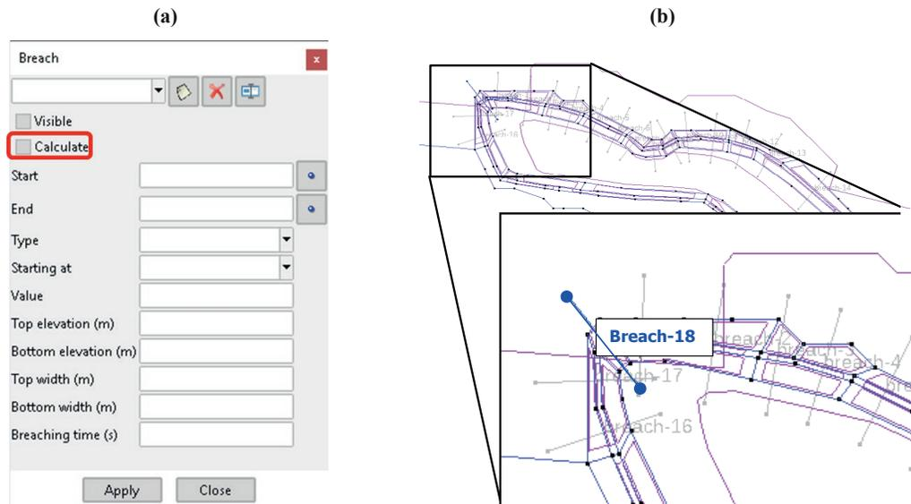
**Figura 4** | (a) Nueva ventana para la definición de los parámetros de la brecha, tipo de brecha y cálculo. (b) Ejemplo de un modelo numérico con diversas brechas definidas automáticamente mediante la selección del dique norte de la balsa: las brechas inactivas permanecen en gris; las brechas activas (p.ej. ‘breach-18’), se muestran en azul (la brecha activa se ha resaltado con fines visuales).
