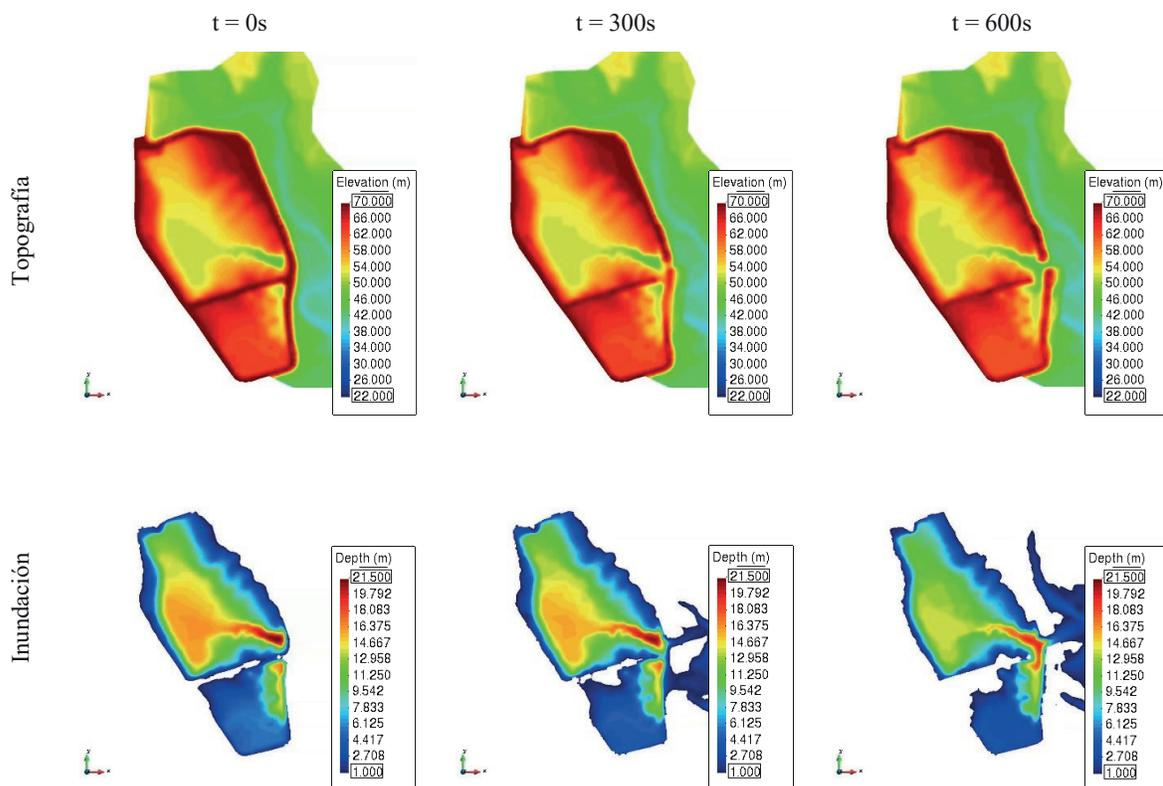
**Figura 5** | Ejemplo del proceso de formación de una brecha por desplazamiento del dique mediante el cambio en la topografía (arriba) y subsiguiente proceso de inundación (abajo) por la formación de una brecha.
