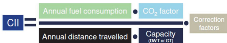
Figura 2. Cálculo de Carbon Intensity Indicator (CII). Fuente: DNV
