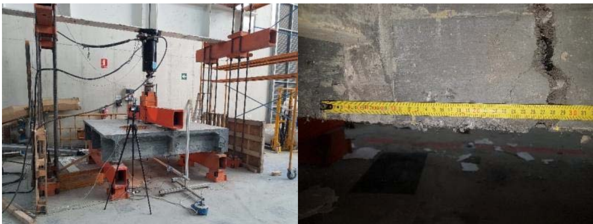
Fig. 9 Disposición del ensayo a flexión y fisura en viga principal. Fase 2
