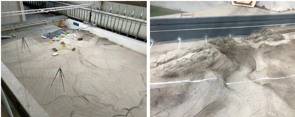
Fig. 3. Reproducción de la compleja batimetría del modelo físico. Fuente: ECOREL, UPM (2021)
