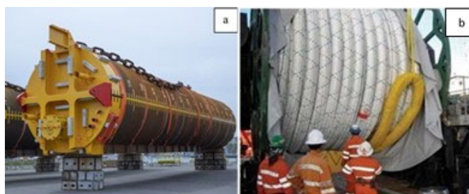
Figura 7. a) Pilotes de succión de 5.5 m de diámetro y tramo de línea de anclaje de poliéster de la plataforma el Perdido
