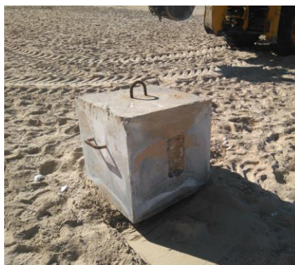
Fig. 2 Bloque de hormigón empleado para la monitorización del hundimiento
