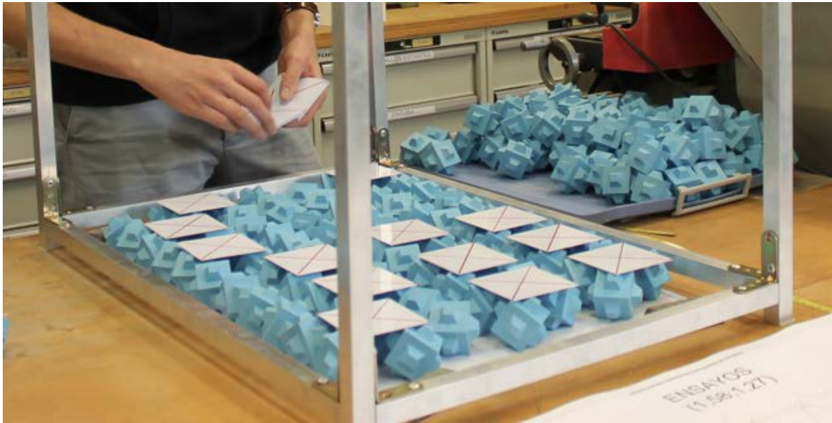
Figura 4. Colocación de cartulinas para medir los espesores de capa como diferencia de cotas de las envolventes de capa
