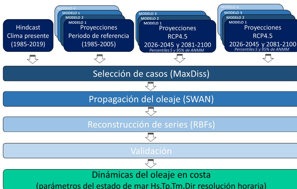
Fig. 4 Esquema de la metodología de downscaling híbrido implementado para la transferencia de las proyecciones climáticas de oleaje a ubicaciones costeras y generación de la base de datos DOW – Proyecciones.
