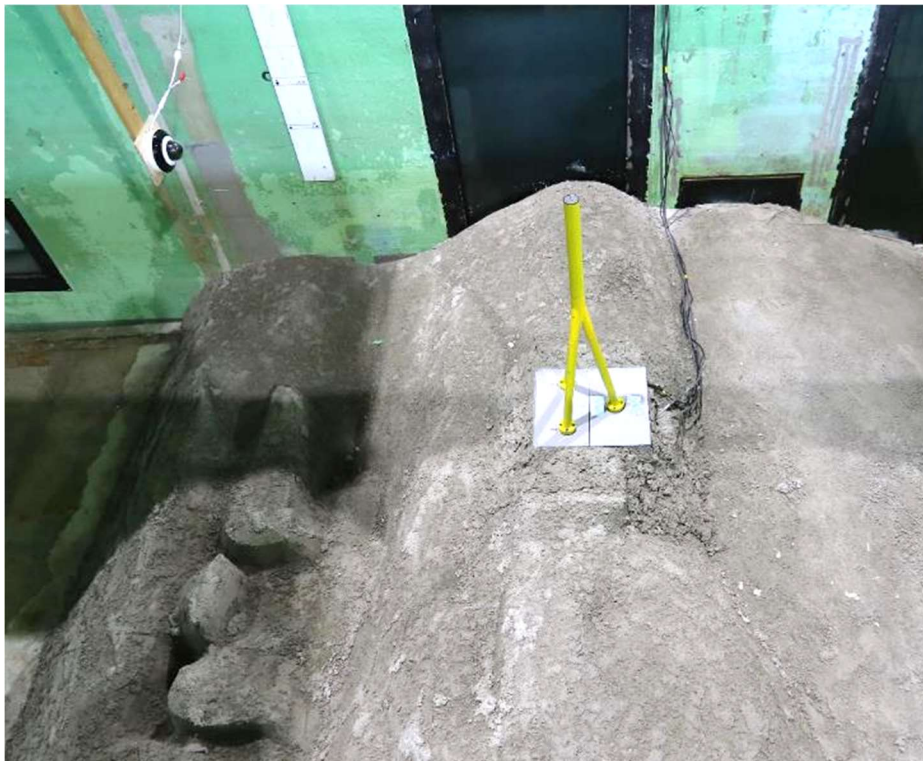
Fig. 3. Detalle de la baliza y de la batimetría, en la zona de emplazamiento, reproducidas en el canal de ensayo.
