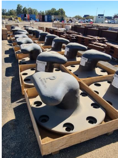
Fig. 14 Bolardos antes de su instalación
