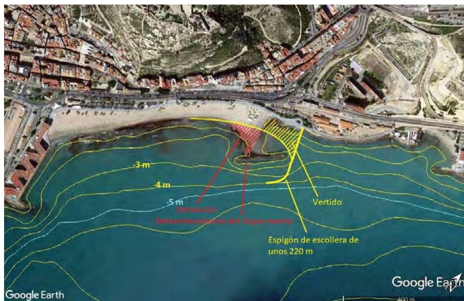
Fig. 8: Propuesta de mejora de la playa de El Postiguet. En rojo el área de arena a extraer y eliminación del dique exento y en amarillo el área a rellenar con arena y construcción del espigón de cierre (Foto: Google Earth)
