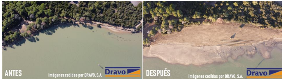
Fig. 9 Alimentación de la margen en Doñana. Fuente: Dravo, S.A. (2022)
