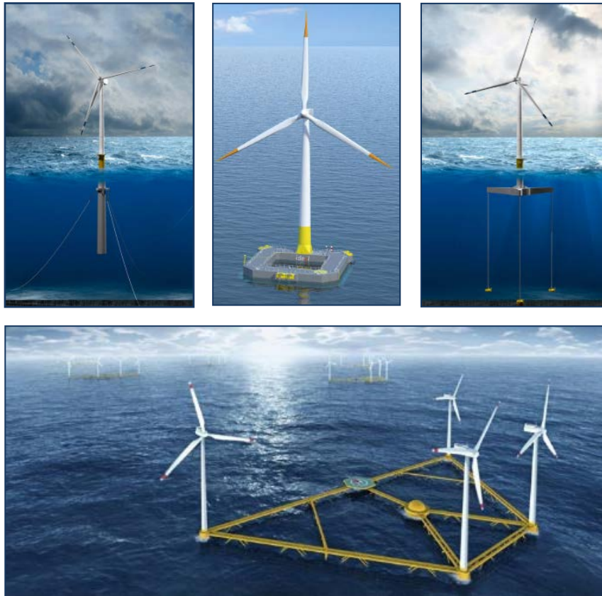
Fig. 2. Soportes flotantes: spar, semisumergible, TLP y multi-turbina
