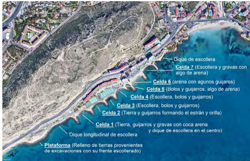
Fig. 9: Estado actual de la playa de Serragrossa, con los terrenos ganados al mar y obras de defensa (Foto: Google Earth)
