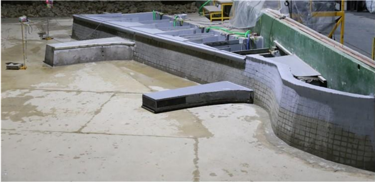
Fig. 12 Modelo físico de la Situación 6, donde se incorpora a la Situación 5C un nuevo espigón coronado a la +0.55 m, a escala de prototipo
