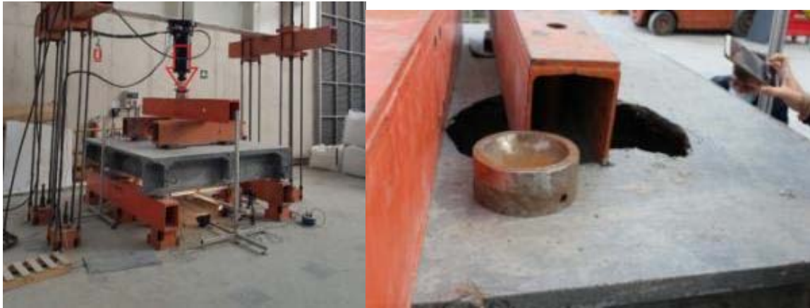
Fig. 7 Disposición del ensayo de punzonamiento y rotura del casetón. Fase 1
