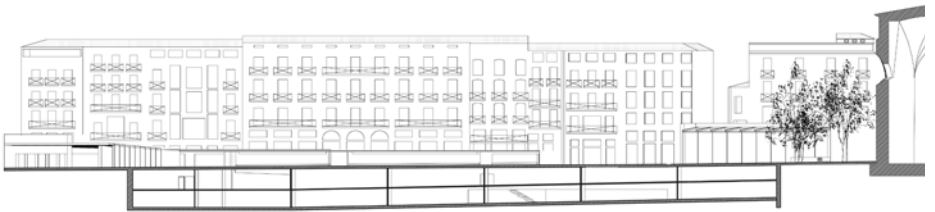
Sección longitudinal por el garaje
