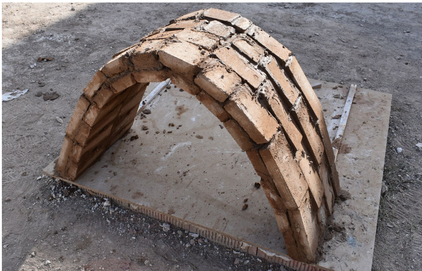
Prototipo de bóveda tabicada de BTC con mortero de tierra.
