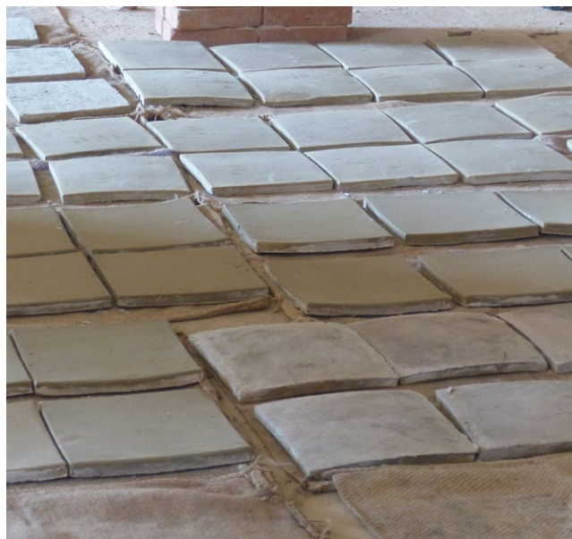
Baldosas conformadas con barro arcilloso dispuestas a arear antes de su introducción en el horno cerámico.
