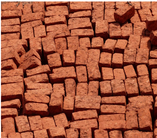
Bloques tallados de laterita apilados, esperando su puesta en obra.
