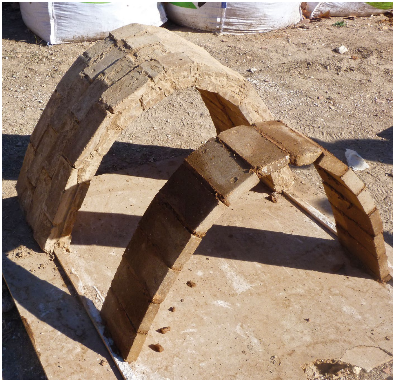
Dos prototipos de bóveda tabicada de tierra.
