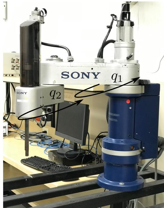
Figura 10: Robot tipo SCARA como plataforma experimental.
