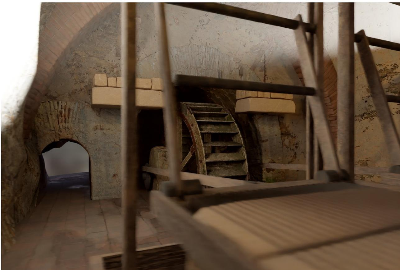
**Figura 12:** Vista interior de la serrería donde puede apreciarse parte del cárcavo y la noria junto a parte del sistema de serrado.
