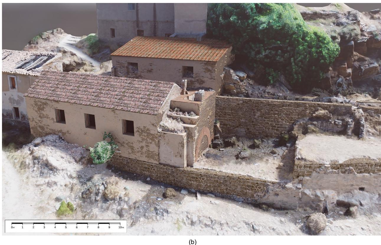
**Figura 8:** Superposición de los principales elementos de la reconstrucción sobre el modelo fotogramétrico de la fábrica de Pedro Nicoli: a) Vista sin renderizar; b) Vista renderizada.
