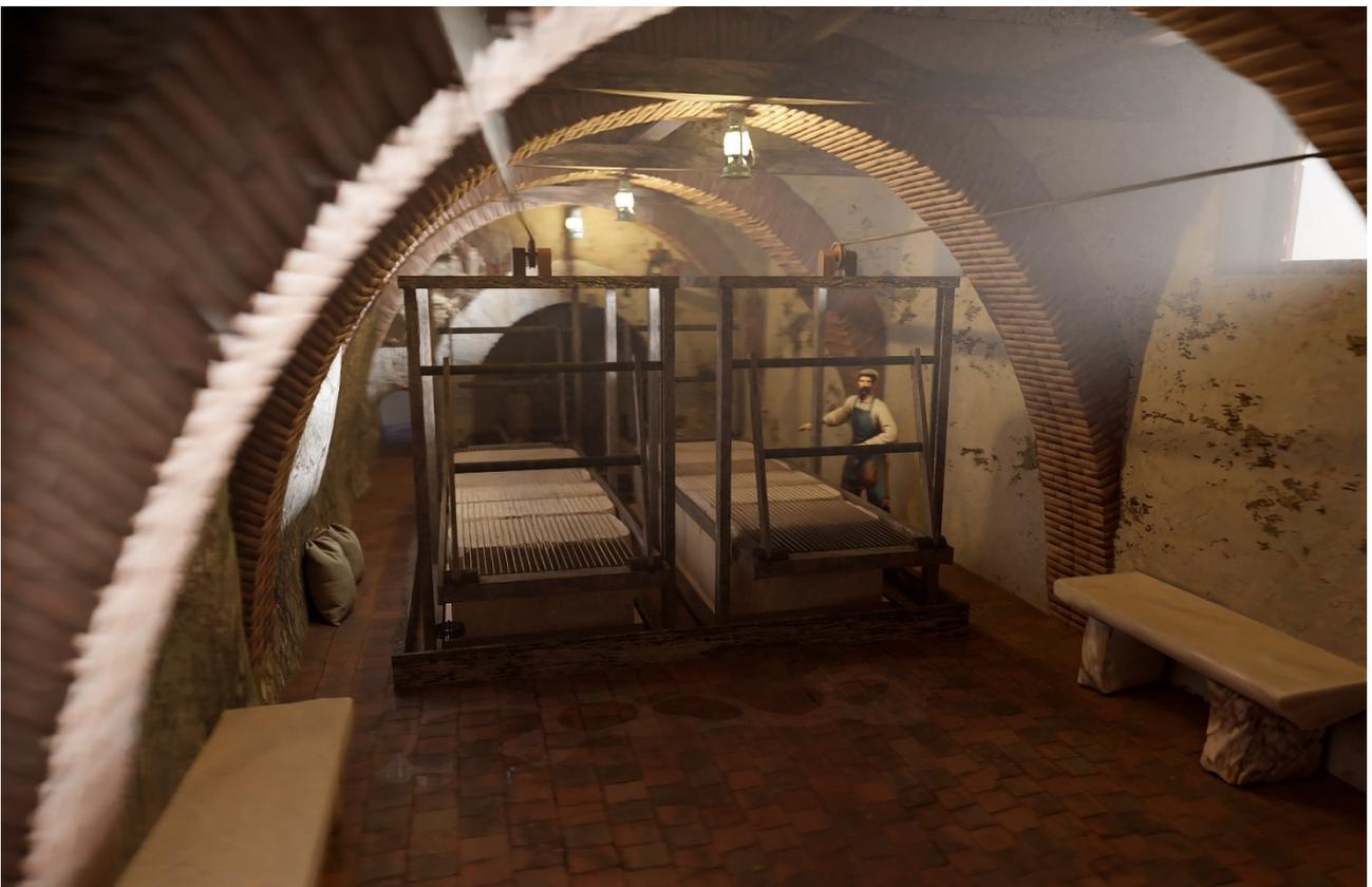
**Figura 10:** Reconstrucción del interior de la serrería hidráulica donde puede apreciarse el amplio espacio interno, los bancos de trabajo y el sistema del arte.
