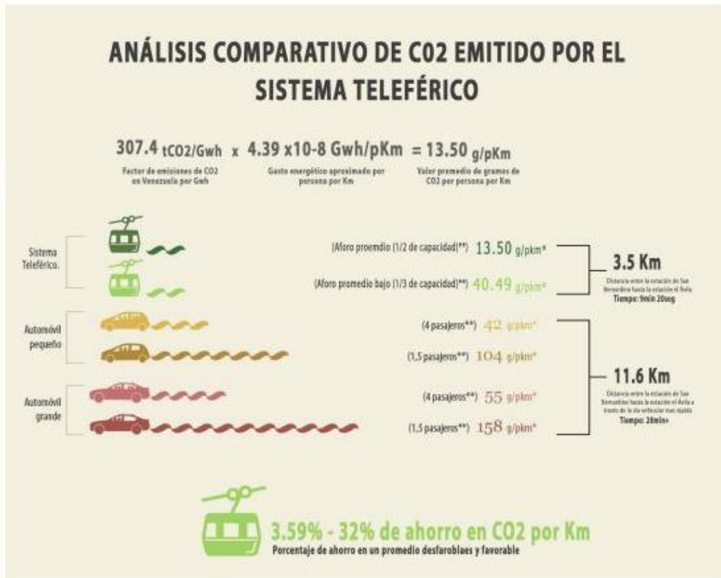
Análisis comparativo de Emisión de CO 2 por sistema de teleférico Fuente: Propia
