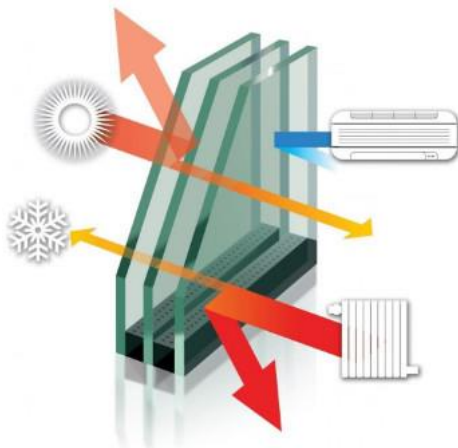
Figura 76. Esquema de funcionamiento vidrio triple. 2024. Fuente: Aluarte.es
