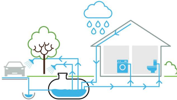
Figura 84. Sistema de recogida de aguas. 2024. Fuente: Premiertechaqua.com
