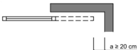
Figura 2.1 Holgura para evitar atrapamientos
