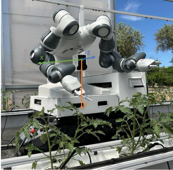
Figura 3: Sistema de coordenadas de las cámaras y el robot.
