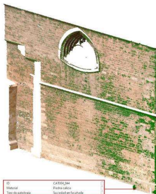
Fig. 8 Nube de puntos convertida en modelo BIM a través de Autodesk® Revit.
