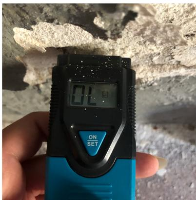
Figura 36. Medición de humedad en el muro mediante higrómetro.
