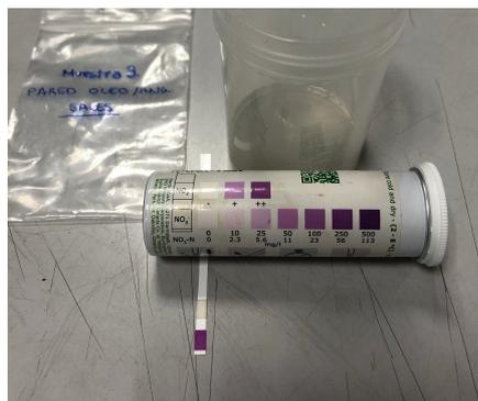
Figura 38. Resultado de la medición de nitratos.
