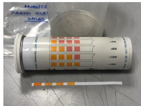
Figura 39. Resultado de la medición de sulfatos.
