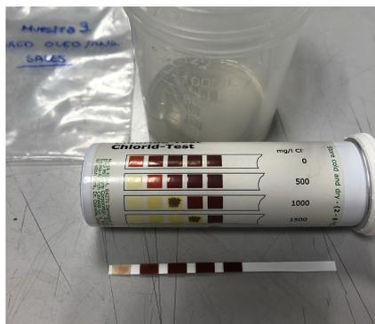
Figura 37. Resultado de la medición de cloruros.
