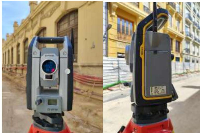
*Ilustración 2. Estación robótica S7 3'' DRPlus*
