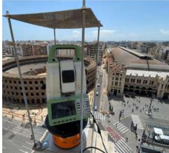
*Ilustración 8. Estación para monitorización*
