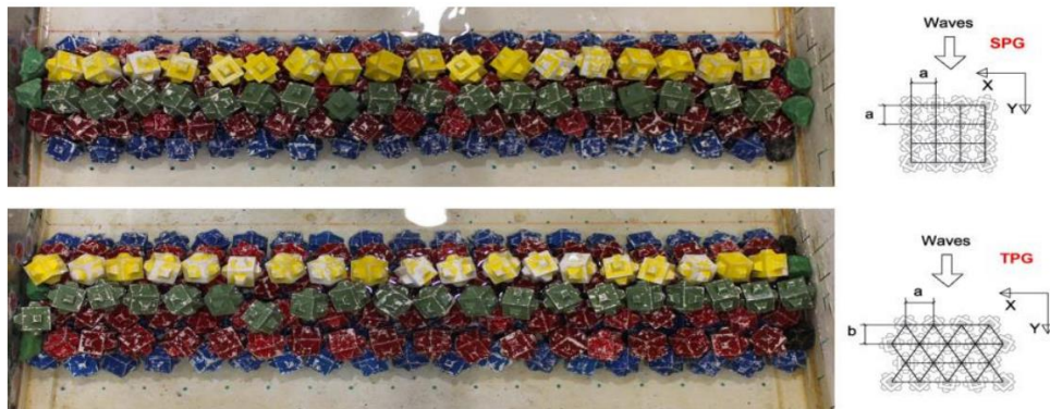
Figura 30: Mallas de colocación del HLCS de Cubípodos ensayada en el canal de oleaje 2D.
