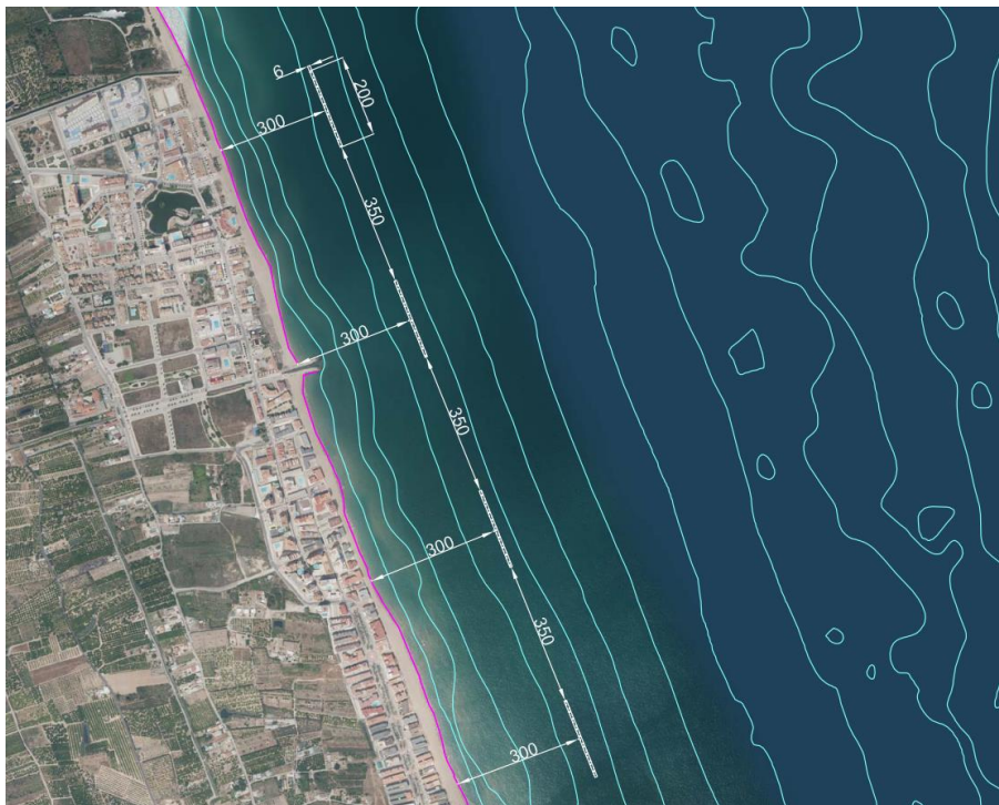
Figura 140: Alternativa 4 de dos diques de 200m.
