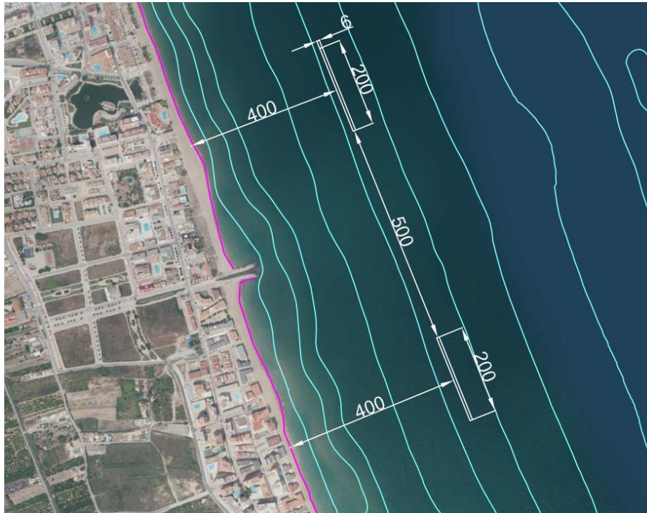
Figura 137: Alternativa 2 de dos diques de 200m.
