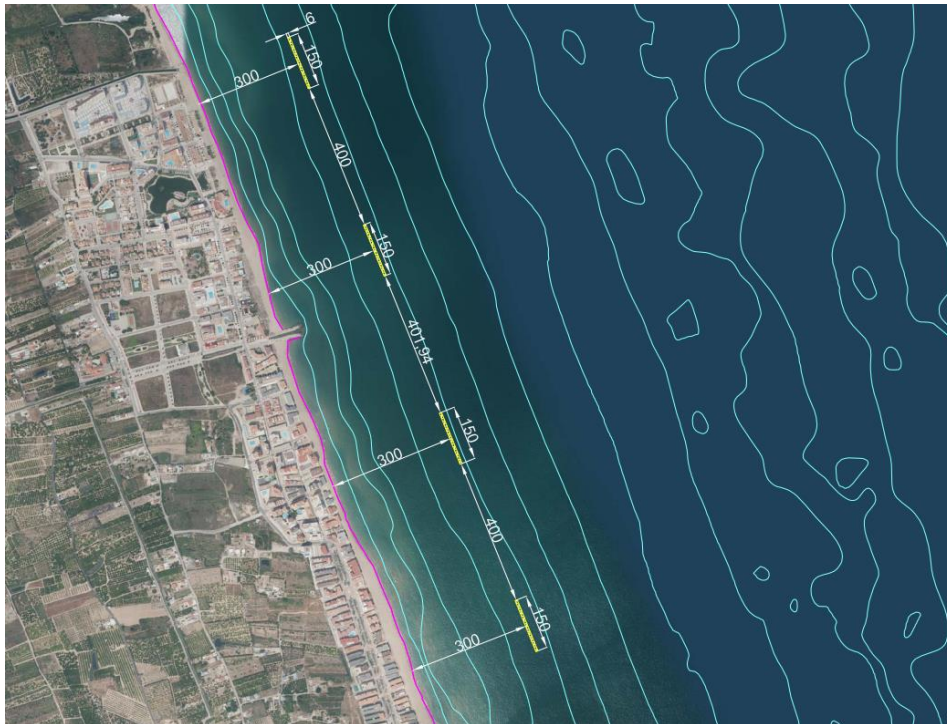
Figura 142: Distancia de colocación de las estructuras respecto la línea de costa.
