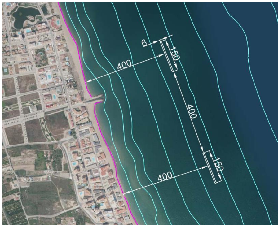
Figura 135: Alternativa 1 de dos diques de 150m.
