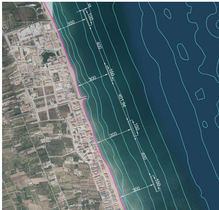
Figura 138: Alternativa 3 de dos diques de 150m.
