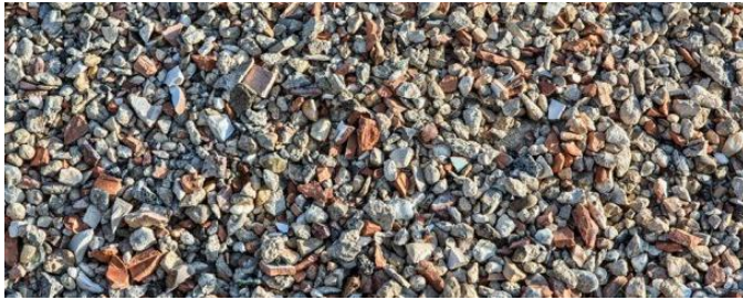
Figura 46. Árido grueso procedente de residuos de construcción. Google imágenes
