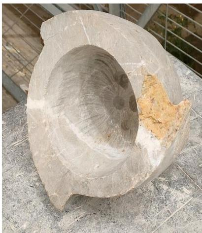
**Fig.33.** Adrián Taylor. 5º El vaciado se desarrolló mediante el uso de un taladro con una broca para piedra, disco de diamante electrodepositado para radial y una fresadora con una fresa de diamante electrodepositado. 2023.
