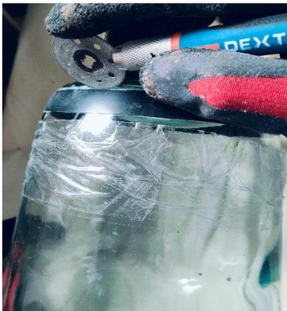
Fig.59. Adrián Taylor. *Corte con disco de diamante electrodepositado*, 2024.
