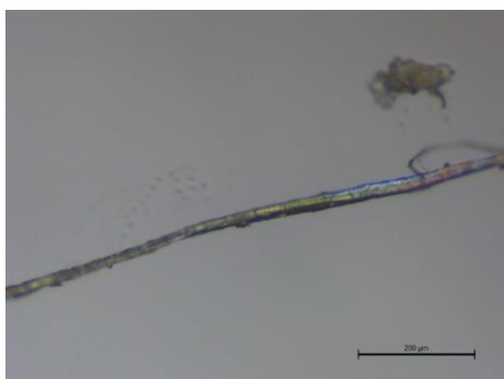
Figura 27. Detalle al microscopio de una fibra del soporte. Fotografía realizada con el microscopio Leica DM 750 a \times 10 aumentos.
