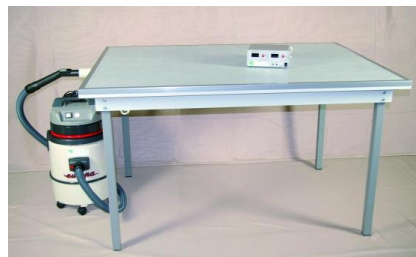
Figura 52. Mesa caliente de baja presión.
