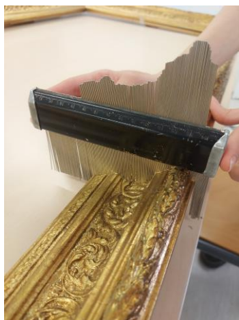
Figura 46. Medidor de perfil compuesto por varillas metálicas capaz de medir 150 mm de largo, conocido también como duplicador.
