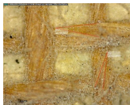
Figura 28. Grado y dirección de la torsión obtenido con microscopio digital Dino-Lite (225x).
