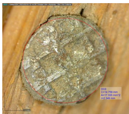
Figura 31. Cabeza de un clavo y su diámetro a 50x visto con el microscopio digital Dino-Lite.
