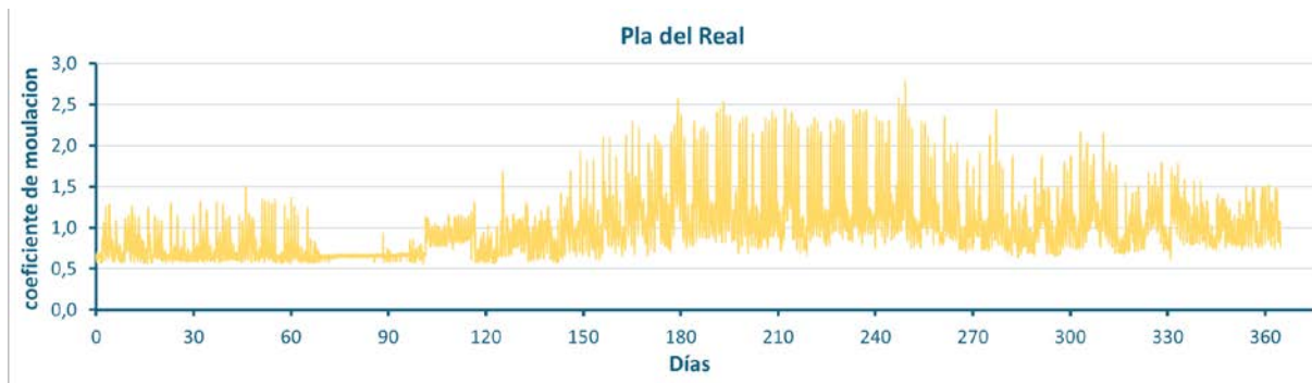
Figura 44: Curva de Modulación Sector Pla del Real.
