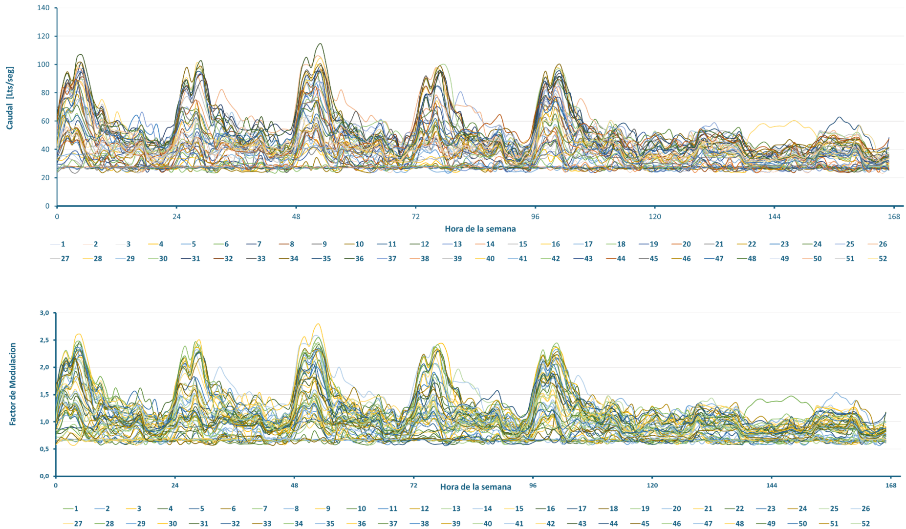
Figura 93: Caudales y coeficientes de modulación del sector Pla del Real en un periodo de tiempo semanal, considerando las 52 semanas del año.
