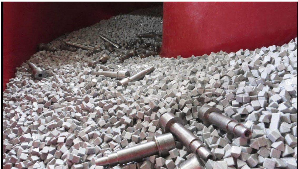
Figura 10. Proceso de vibrado de piezas mediante un método abrasivo.
