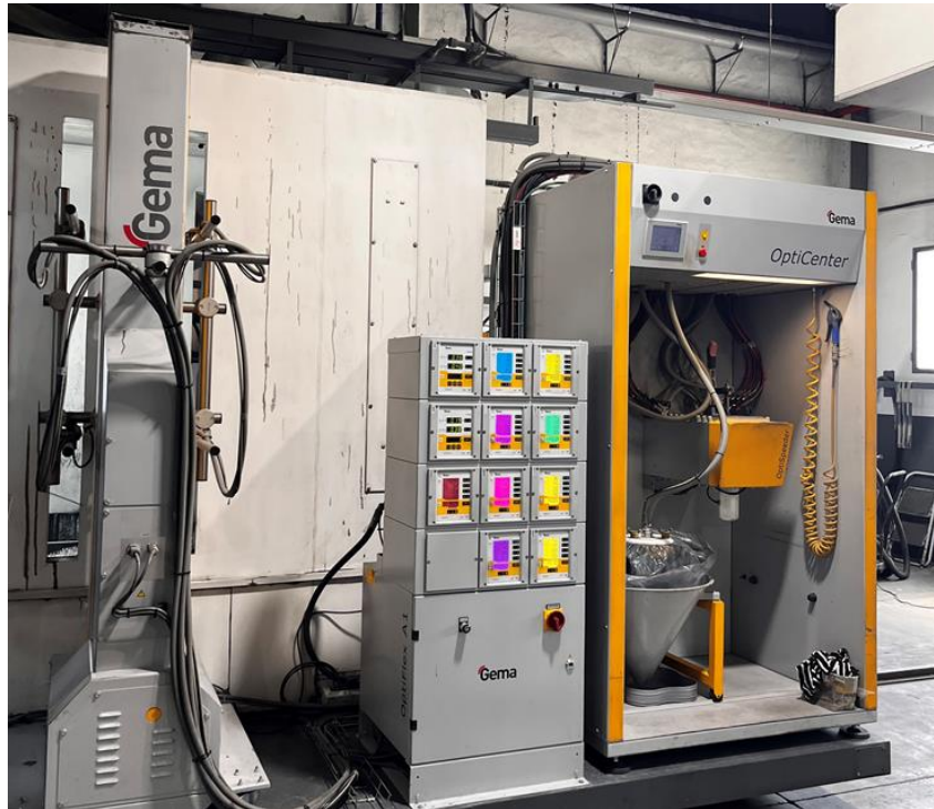
Figura 8. Máquina de lacado de perfiles largos propiedad de Gaviota.
