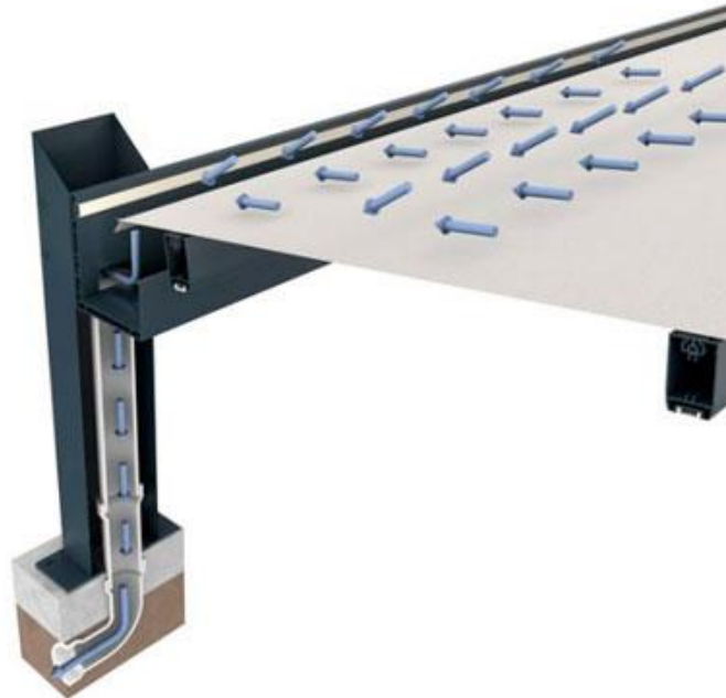
Figura 39. Recorrido de evacuación del agua en la pérgola.
