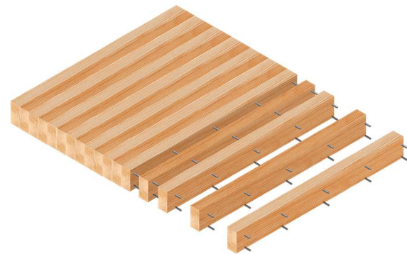
FIG 8. Axonometría funcionamiento sistema NLT.
