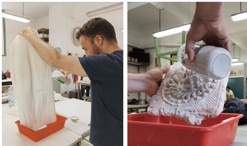
Fig. 6. Proceso de esmaltado mediante la técnica del vertido de las piezas I y III.
