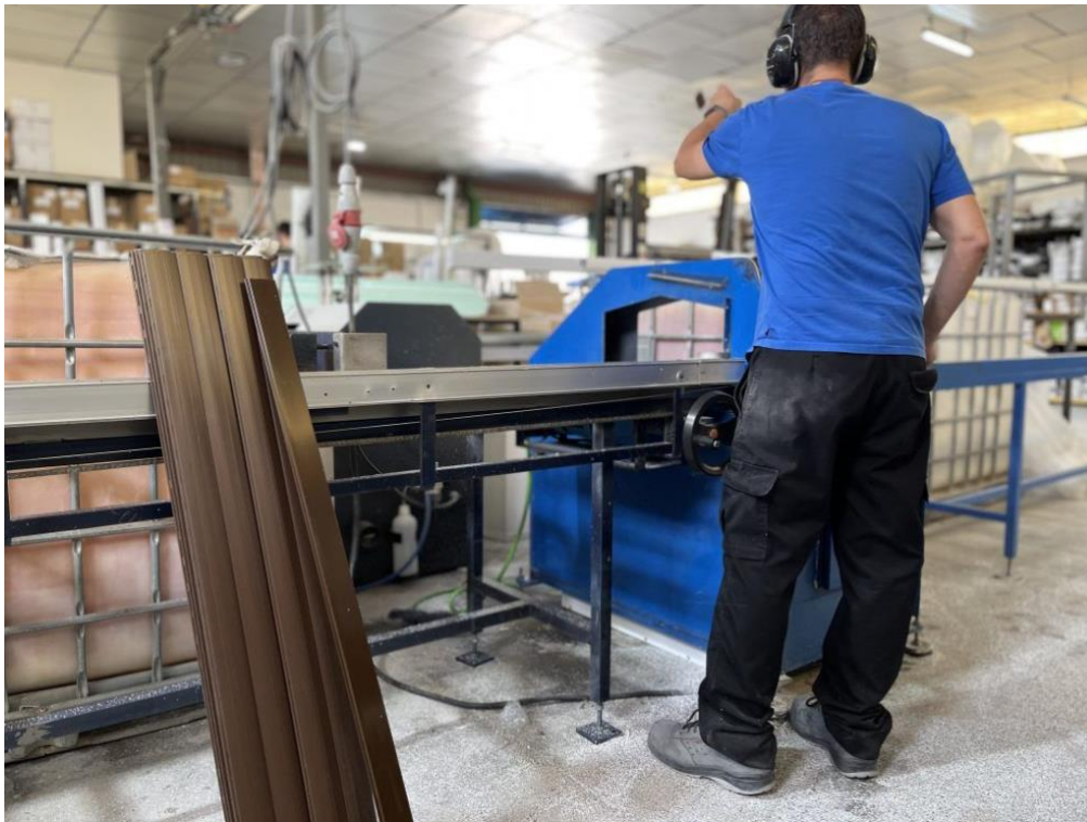
Il·lustració 15: Màquina corte de lames. Fuente: https://novapersi.es/galeria/
