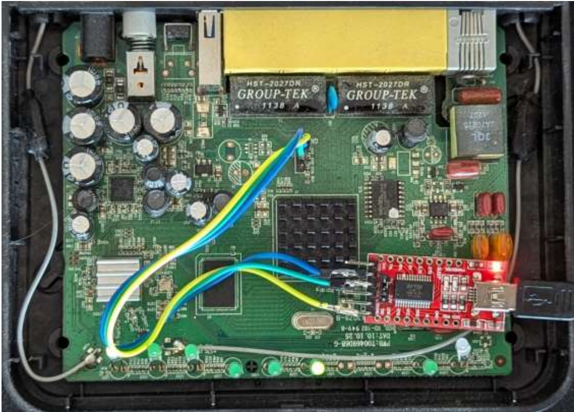
Ilustración IV Conexión del convertidor UART con el dispositivo. Elaboración propia.
