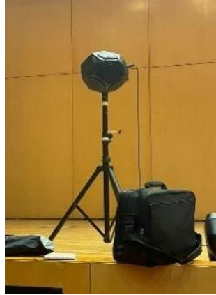
Ilustración 11: Fuente dodecaédrica Omni-Power, Modelo 4292-L
