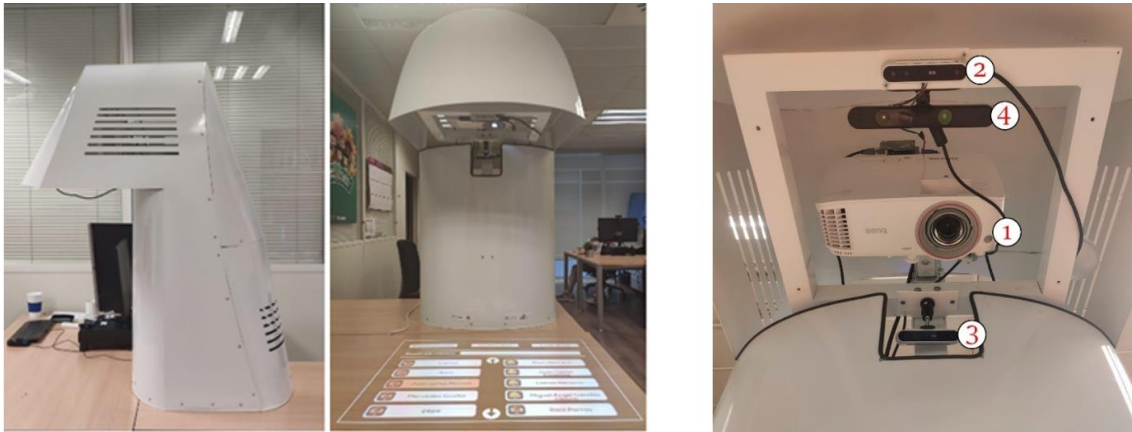
Figura 4. Estructura y dispositivos del Sistema de Realidad Virtual.
