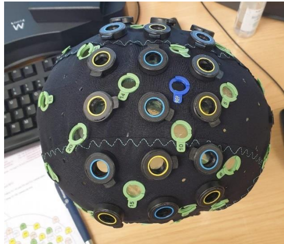
Figura 8. Casco para la colocación de los electrodos.
