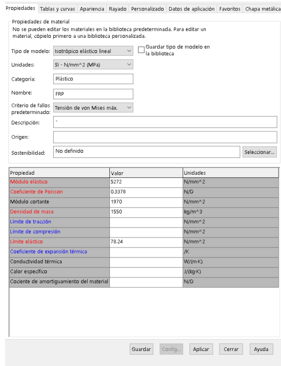
Ilustración 57 - Propiedades poliéster reforzado con fibra de vidrio
