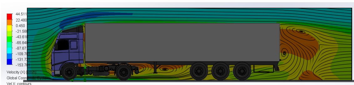
Ilustración 20 - Líneas de flujo en el plano medio
