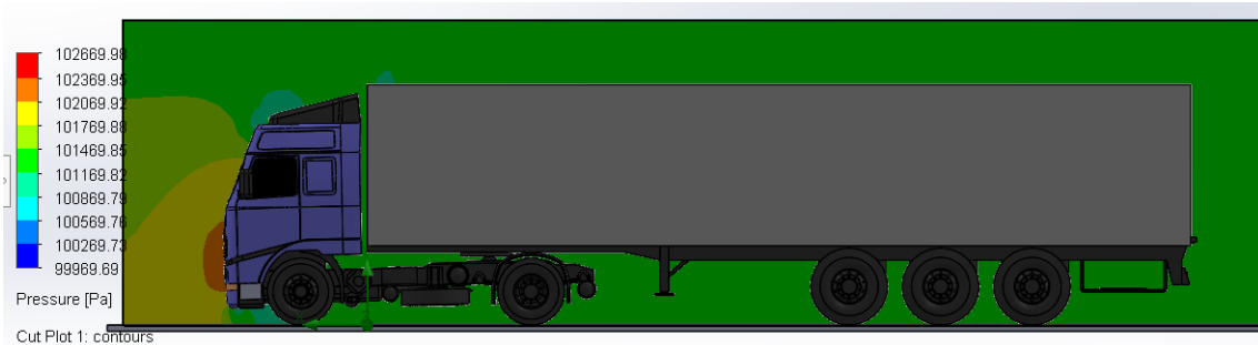
Ilustración 18 - Contornos de presión en el plano medio
