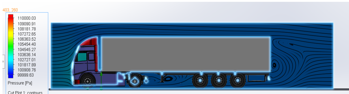
Ilustración 47 - Contornos de presión en el plano medio
