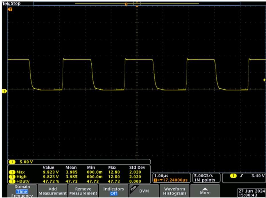
Figura 62. Entrada del driver ir2110 con 50% ciclo de trabajo
